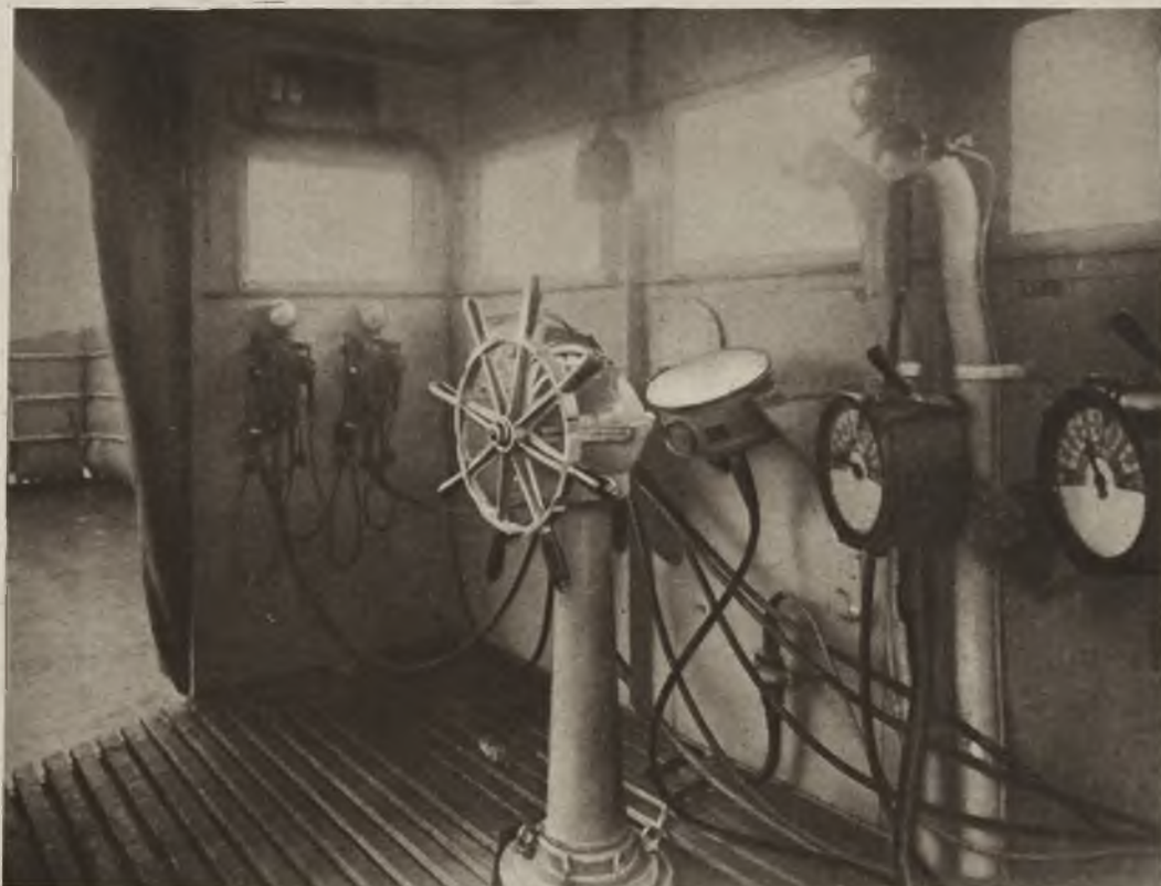
Pierwsza próba kierowania okrętem z daleka. U góry wnętrze kabiny sterowej okrętu „Zähringen”, który bez załogi odbył podróż po morzu północnym. U dołu ogólny widok okrętu.
