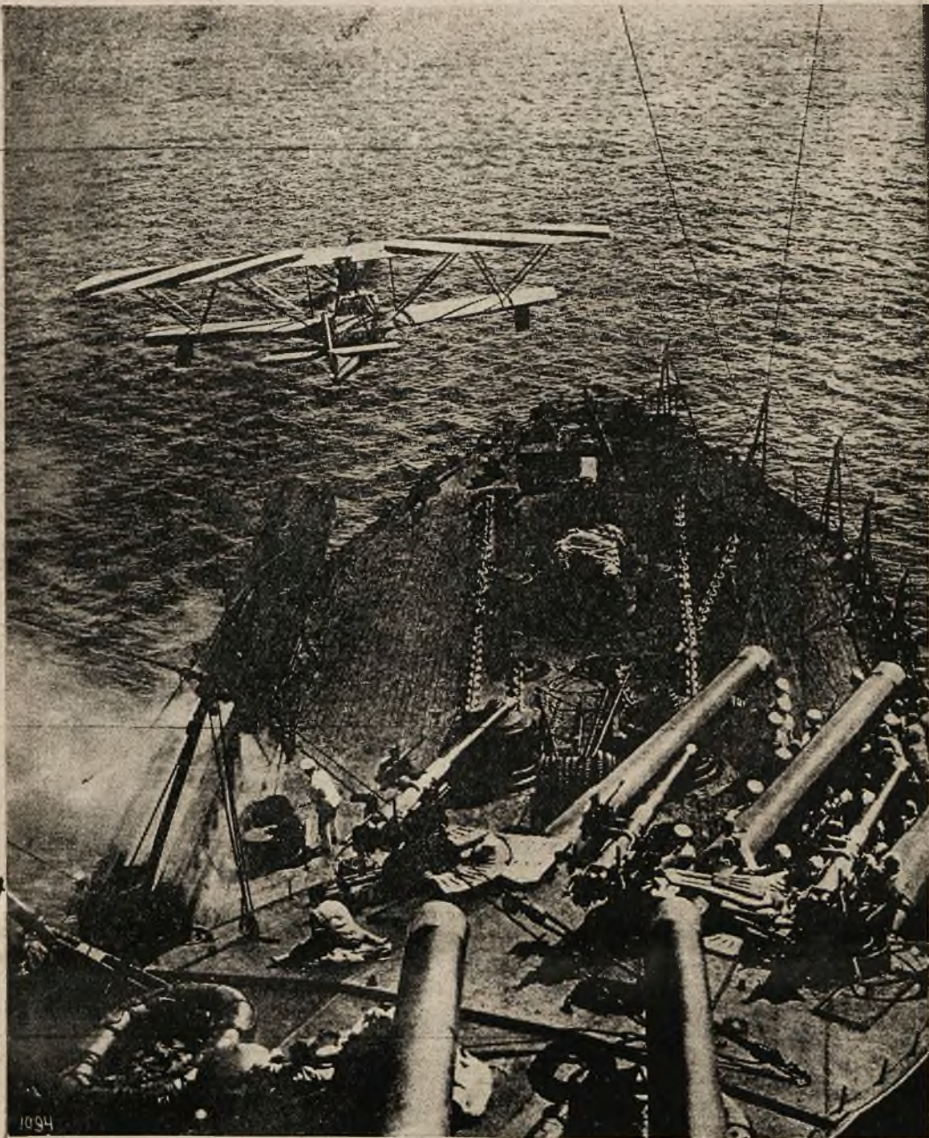
Awjatyka na morzu. Startowanie samolotu z pokładu włoskiego okrętu wojennego przy pomocy specjalnie urządzonej katapulty.
