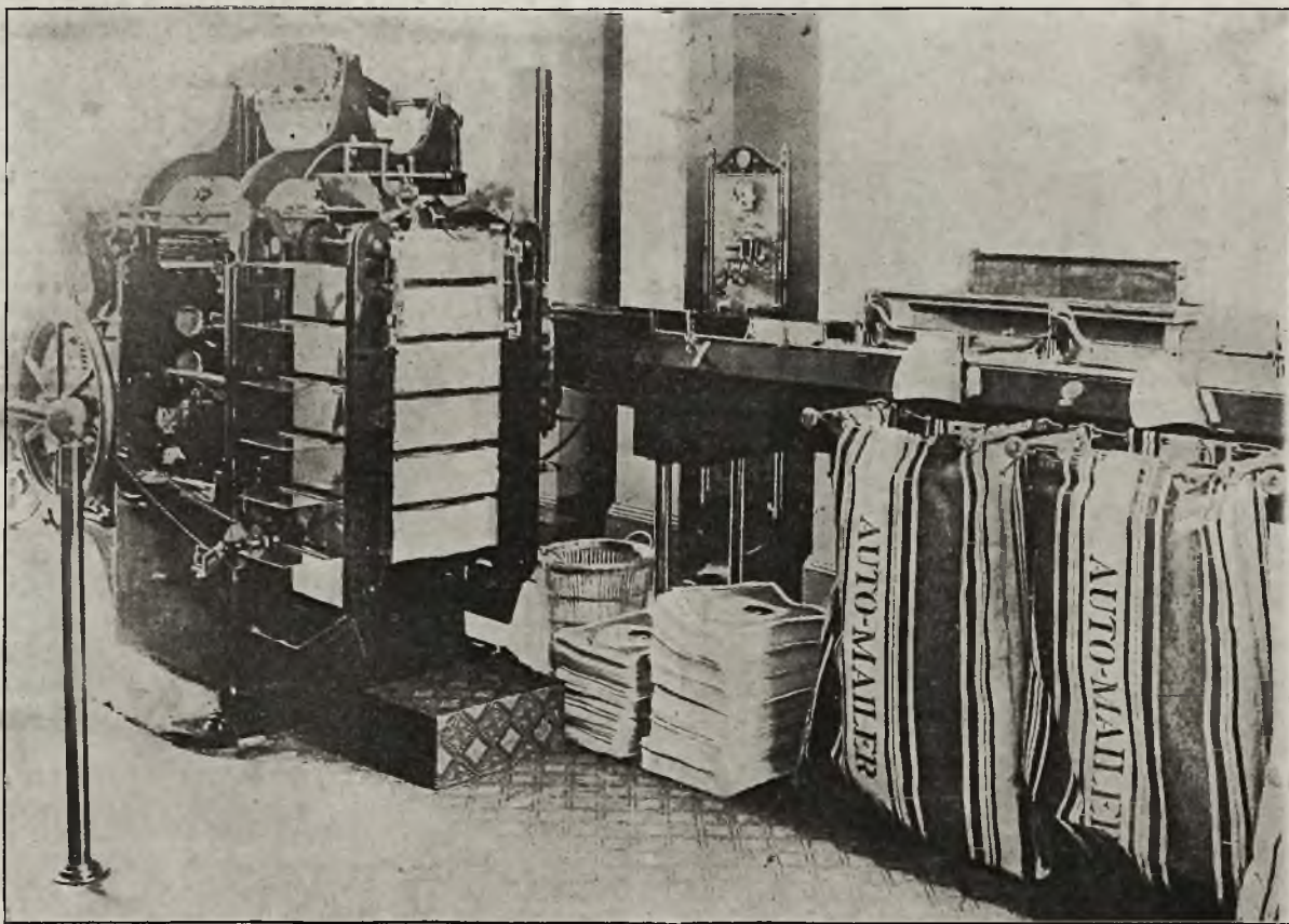
Nowy wynalazek drukarski: Wynaleziona w Londynie maszyna do falcowania i frankowania czasopism.
