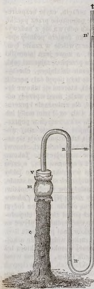
220. c Latorośl winna ucięta pięć decymetrów od ziemi. — t Rurka szklana dwa razy zgięta, tkwiąca w kółku mosiężnym v , przystosowanem do uciętej kończyny latorośli i oblepionem. Kończyna ta i kółko obwiązane są ka
