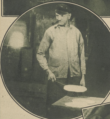
W kole: JEDNO SPOBIENIE W GRĘB HUTY SZKLANEJ Materiał mozaikowy przelapia się przy 1300° C z piasku czystego, węglałów niektórych metali i ługów w płytki wielkości laleczki o grubości około 1 cm.
